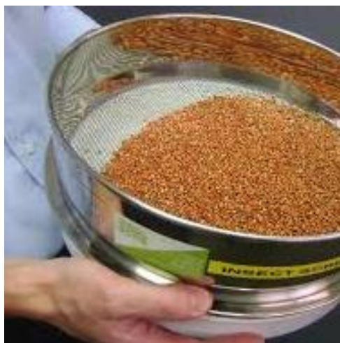
ภาพที่ 6 การเตรียมตัวอย่างดินเพื่อวิเคราะห์ทางเคมี
