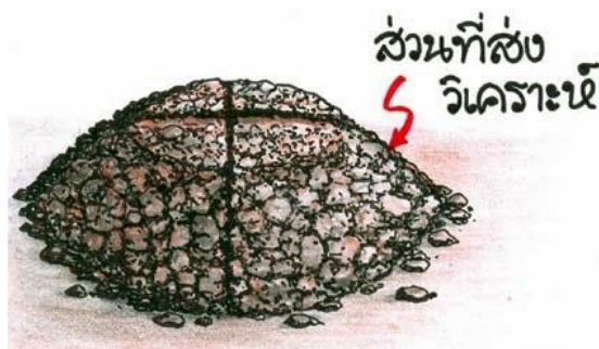
ภาพที่ 5 แสดงการแบ่งดินออกเป็นสี่ส่วนและนำหนึ่งส่วนส่งวิเคราะห์
