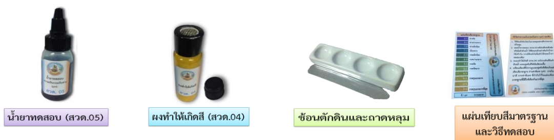
ภาพที่ 7 แสดงอุปกรณ์ชุดตรวจสอบภาคสนามความเป็นกรดเป็นด่างของดิน
